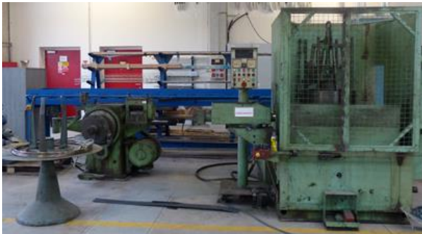
Drátotah pro průměry 15-0.2 mm
