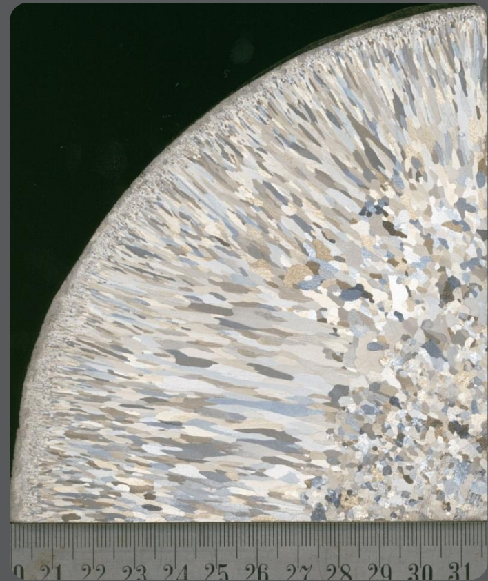
Macrostructure – heel /alloy pin FeNi42
