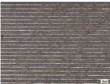
Vrstvený válcovaný ocelový plech
