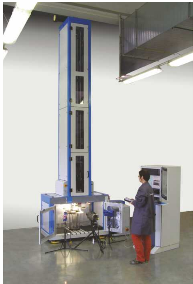
Padstroj, energie nástroje 3000 J, max. rychlost zatěžování 25 m/s
