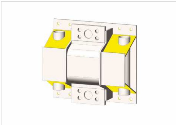
Segment odebraný pro zkoušku únavy
