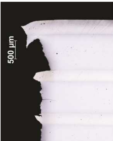
Testování vrubové houževnatosti vrstveného plechu
